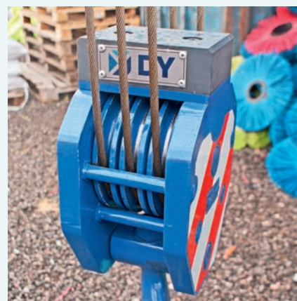
Фторопластовая подушка защищает подвеску крюка от ударов об оголовки
