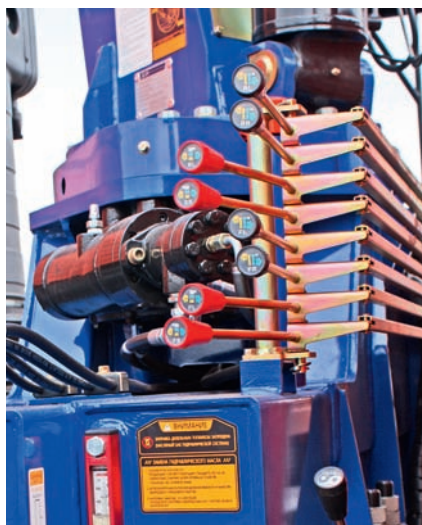
С уровня земли оператор может только управлять выдвижением опор
