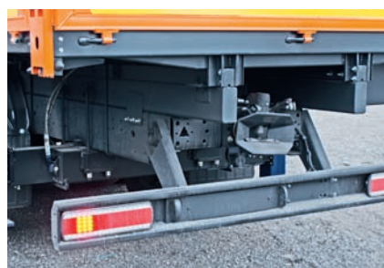
Шасси КАМАЗ-65115 оснащается штатным прицепным устройством
