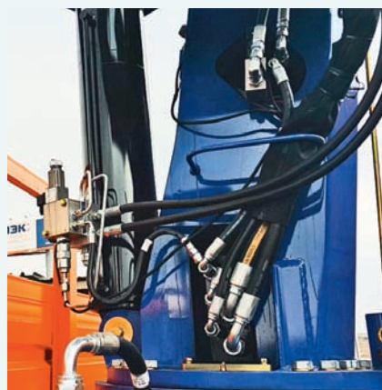
Блок новой системы безопасности установлен на подъемном цилиндре
