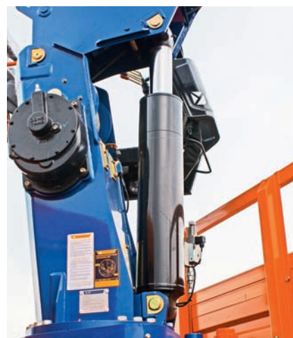
Для подъема стрелы применен гидроцилиндр повышенной прочности
