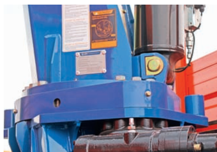
Большое количество болтов обеспечивает прочность крепления основания
