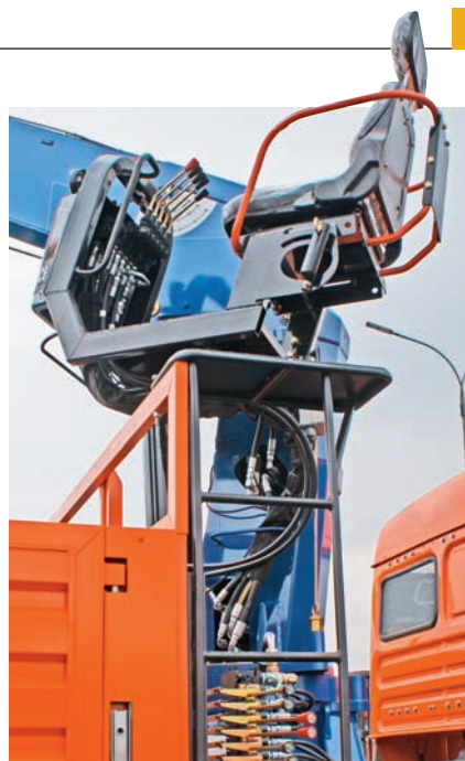
Управлять краном с большим вылетом стрелы удобнее с верхнего поста, который оснащен эргономичным креслом
