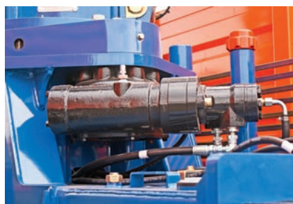
Гидравлический редуктор обеспечивает вращение полноповоротной колонны
