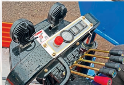
Верхний пульт позволяет управлять всеми функциями манипулятора
